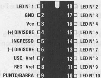
Fig.5 Poiché la piedinatura di questi integrati è identica, in alcune applicazioni potrete sostituirli uno con l'altro.
