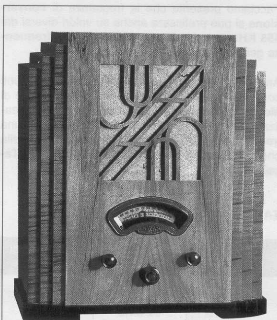
Fig.372 Con il passare degli anni si cercò di rendere il mobile di queste radio esteticamente sempre più moderno. Come potete notare, la scala della sintonia con sopra stampata la frequenza in KHz per le OM e in MHz per le OC, risulta più ampia.
