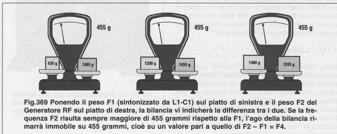
Fig.368 Ammesso di considerare i KHz dei PESI in grammi, se sintonizzate il circuito L1-C1 di fig.365 sui 630 KHz e ponete questo ipotetico peso su una bilancia, questa vi indicherà 630 grammi, se invece vi sintonizzate su 1.200 KHz o 1.480 KHz la bilancia vi indicherà rispettivamente 1.200 grammi e 1.480 grammi.
