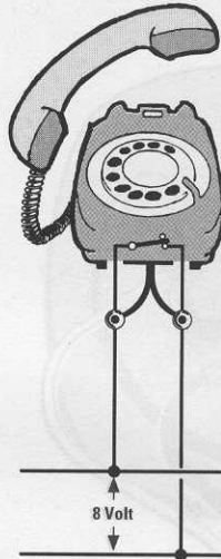
Fig.2 Quando la cornetta viene sollevata, la tensione di 40 volt presente sulla linea si chiude su un carico di 600 ohm e, automaticamente, la tensione scende sugli 8 volt.
