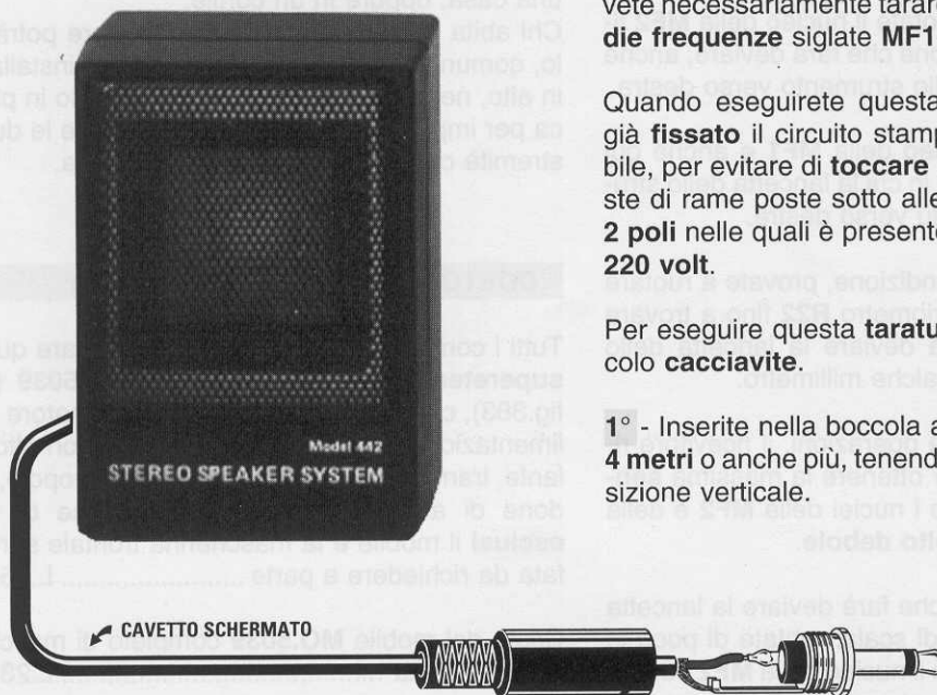
Fig.385 Dalla piccola Cassa Acustica, contenente l'altoparlante, fuoriesce un sottile cavetto schermato. Dopo aver spellato la sua estremità in modo da separare i due fili, dovete saldare quest'ultimi sui terminali del connettore jack maschio inserito nel kit. Arrocciate bene i sottili fili della calza di schermo per evitare che ne rimanga qualcuno volante.
