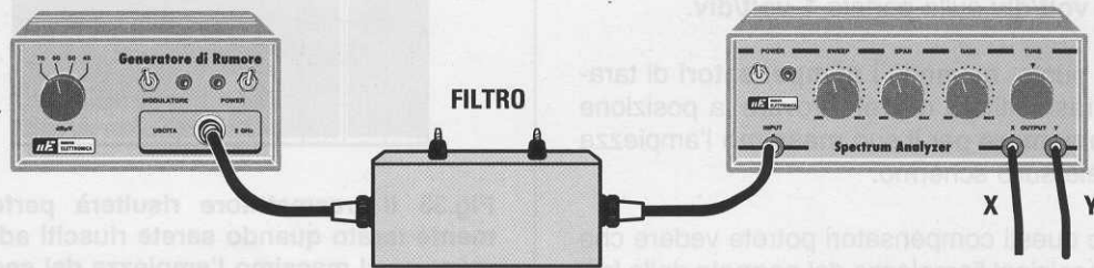
Fig.36 Collegando tra l'uscita del Generatore di Rumore e l'ingresso dell'Analizzatore un qualsiasi filtro Passa/Basso-Passa/Banda o Passa/Alto, potrete visualizzare sullo schermo dell'oscilloscopio la sua curva di risposta.
